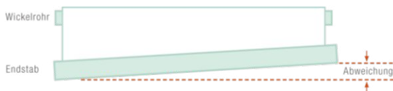
Abbildung 62 Abweichung von der Rechtwinkligkeit
