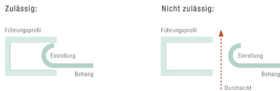
Abbildung 65 Bewertung bei Einrollungen von freien Behangkanten
