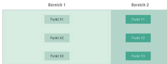
Abbildung 36 Beispiel zur Farbmessung bei Farbunterschieden innerhalb einer Scheibe
